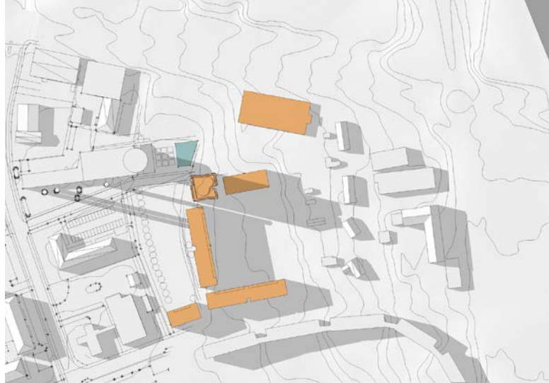
Eksempel på skyggediagram: Skyggepåvirkning ved sommer-solhverv (21. juni), kl. 18:00.
