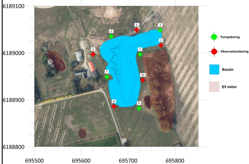
figur 1 Placering af 10 A borer. 5 borer til observation, og 5 borer til grundvandssænkning. Der kan blive skiftet imellem hvilke borer der benyttes til observation og til sænkning.
