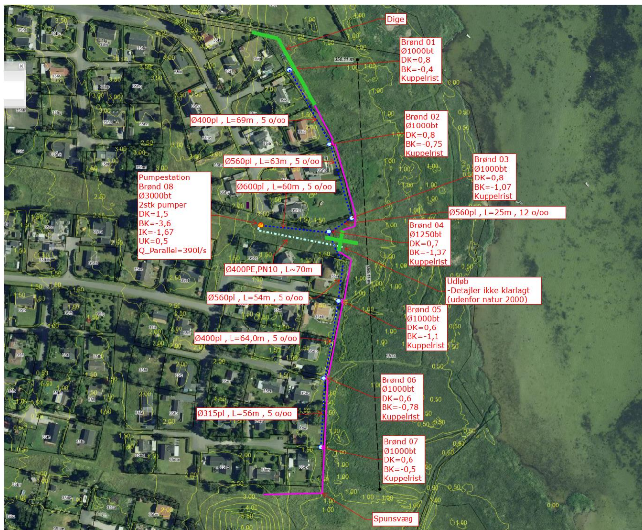
Figur 1 Placering og udgravningskoter for ledning og pumpestation
