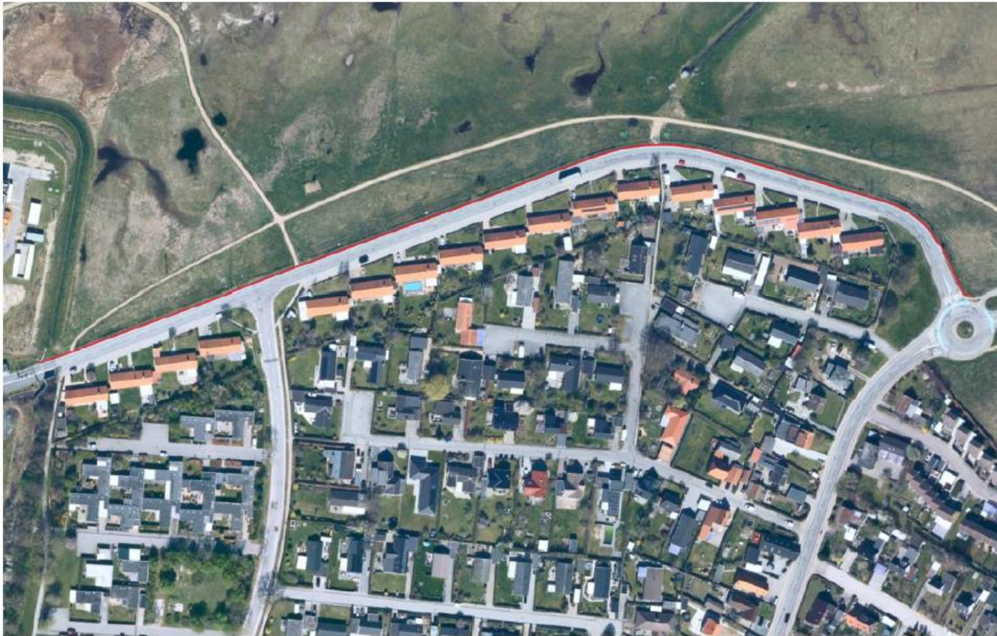
Figur 2-1 Placering af højvandsmur langs med Linderupvej (rød linje). Højvandsmuren er ca. 560 meter lang og strækker sig fra Topsoe A/S til rundkørslen på Byvej. Højvandsmuren drejes rundt langs cykelstien ved rundkørslen for at mindske risikoen for bølgeopløb i rundkørslen, der kan løbe bagom beskyttelsen.
