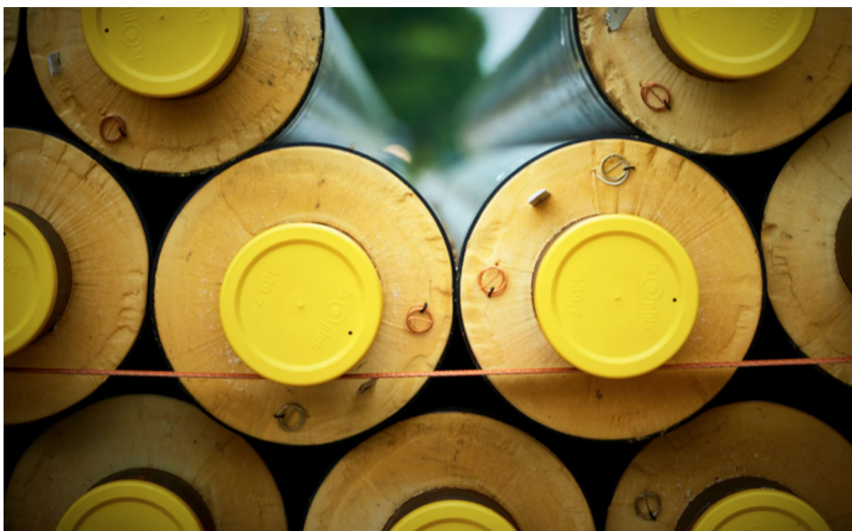
En stak fjernvarmerør.
