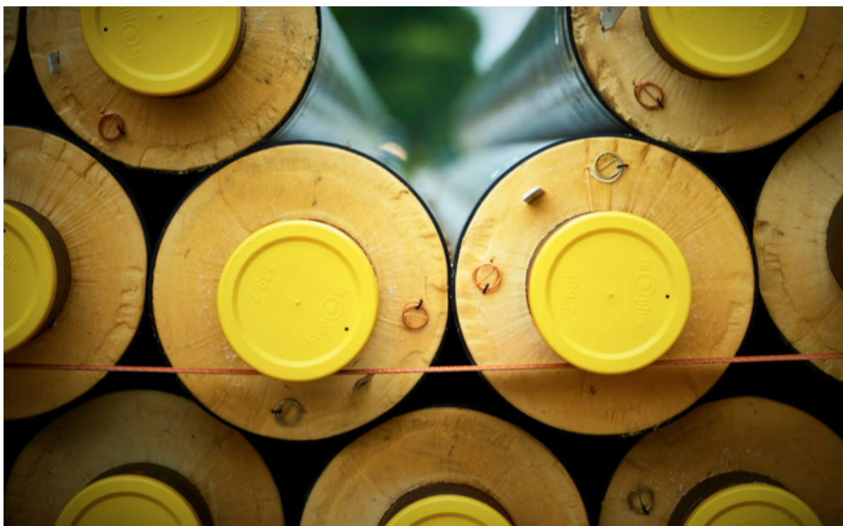
En stak fjernvarmerør.
