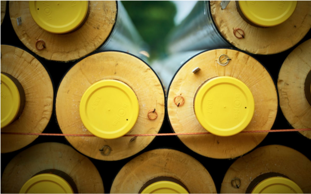
En stak fjernvarmerør.
